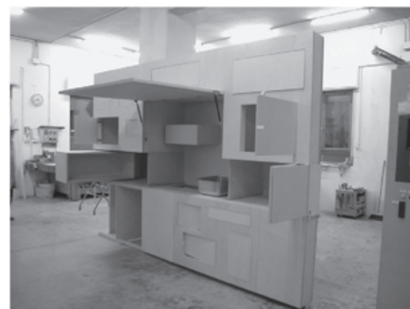
Pour vérification des assemblages, un premier montage est effectué en atelier.
